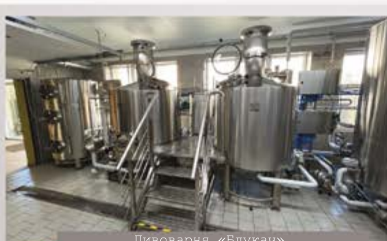
Пивоварня «Блукач». с.Рожище, Волинська обл. Двопосудний варочний порядок об'ємом 500 л/варка з повним автоматичним керуванням. Укомплектовано ЦКТ на 1000 л з автоматичним контролем тиску.
