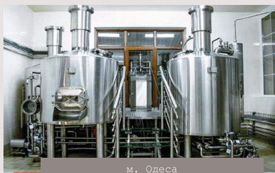
м. Одеса Пивоварня на 500 л, укомплектована ЦКТ на 1500 л та на 2000 л
